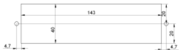
Abbildung 2: Einbauöffnung für Bedientafel (86D).
