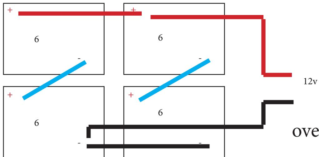
oversikt over mellomkobling av batterier
